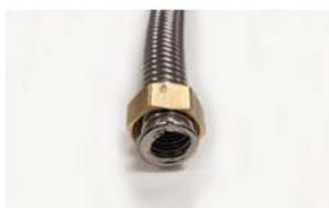
**7** Dévisser complètement l'écrou d'écrasement : le collet battu est réalisé.
