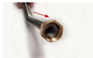
**4** Remonter l'écrou tournant en butée.
