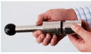
**2** Choisir la tête d'outillage correspondant au diamètre du tube et visser sur le piston.
