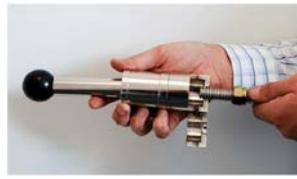
**3** Ouvrir la partie mobile et positionner le tube dans l'encoche à 2 ondes de l'extrémité.
