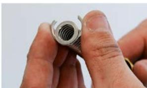
**6** Installer la bague fendue derrière le collet battu et la resserrer.
