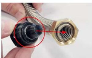
**5** Positionner l'écrou d'écrasement sur l'écrou tournant.
